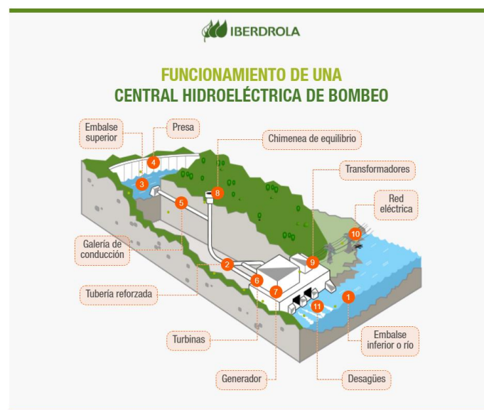
Figura 5: Cómo funciona una central hidroeléctrica de bombeo
