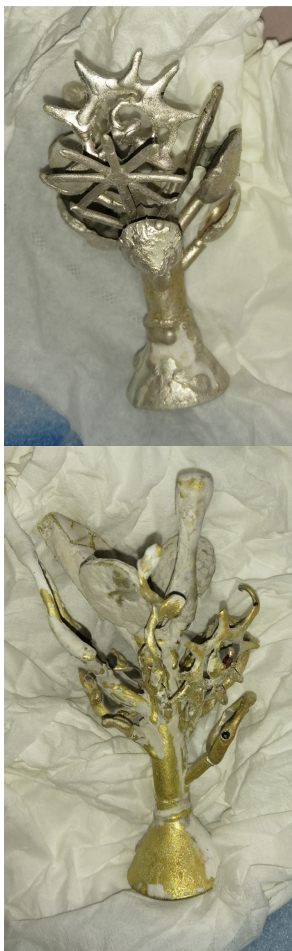
Fig. 39 y 40. Dos árboles de colada con restos de revestimiento. En la parte de abajo podemos observar que tiene forma de embudo, eso es la mazarota.
