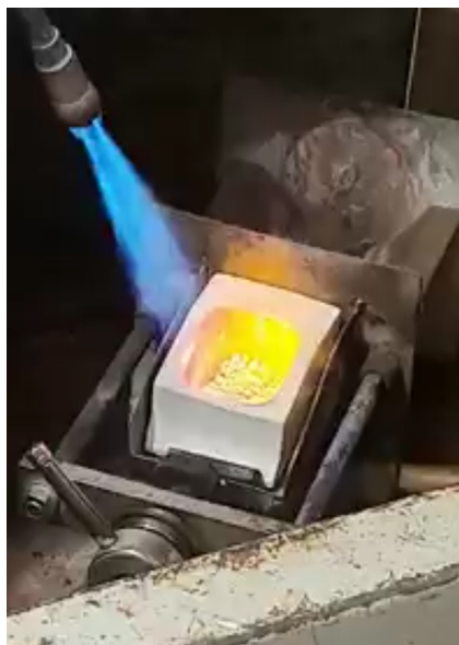
Fig. 41. El crisol en el interior de la centrifugadora. El cilindro aún no está colocado porque se ha de esperar a que el metal esté fundido del todo.
