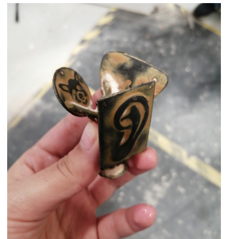
Fig. 32. Árbol de plata recién colado, aún con restos de revestimiento. El color se debe a la oxidación que produce el fuego.
