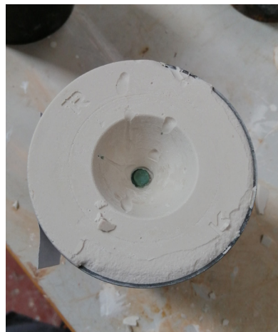
Fig. 31. El cilindro lleno y después de retirar la base de caucho. Está preparado para licuar.
