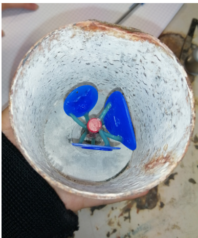
Fig. 30. El cilindro colocado y listo para el llenado.
