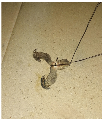
Fig. 42. Pieza de plata sobre un ladrillo refractario. El pincho está sujeto con hilo de atar para evitar que se mueva durante el proceso de soldadura.
