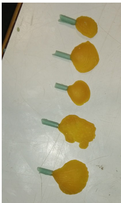
Fig. 37. Reproducciones en cera de elementos marinos a partir de un molde de silicona con el bebedero colocado.
