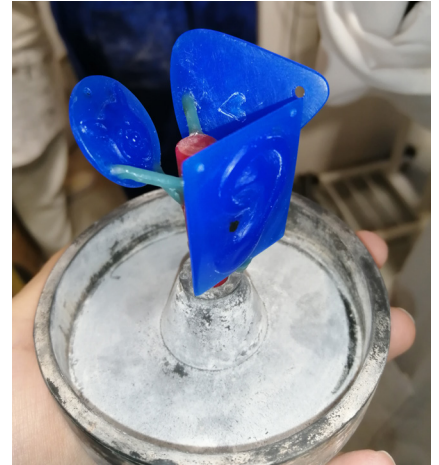
Fig. 29. El árbol de colada ensartado en una base de caucho.
