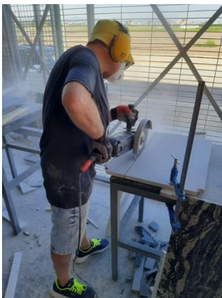
Fig. 29. Adrián Taylor. Corte largo con radial de 220mm. 2022.
