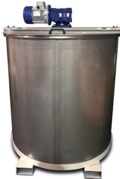
Figura 15. Depósito cilíndrico de acero inoxidable con sistema de agitación.
