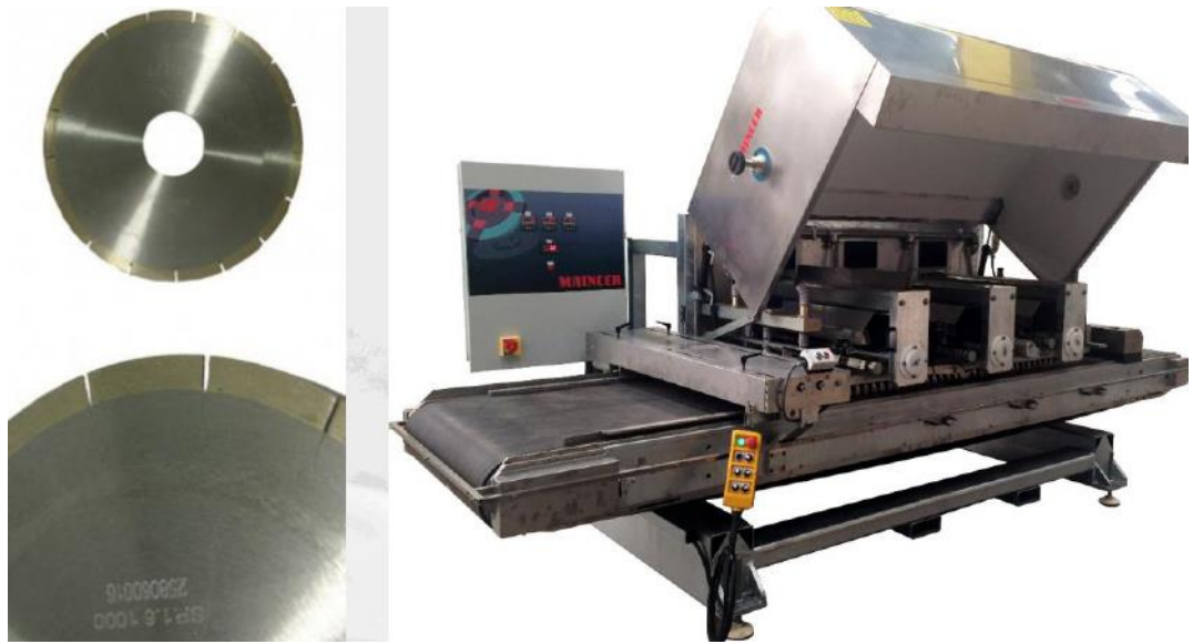
Figura 5. Máquina y discos de corte de azulejos MAINCER.
