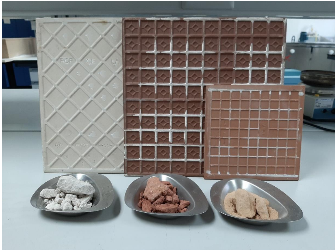
Figura 14. Arcillas y soportes cocidos para porcelánico, gres y porosa.
