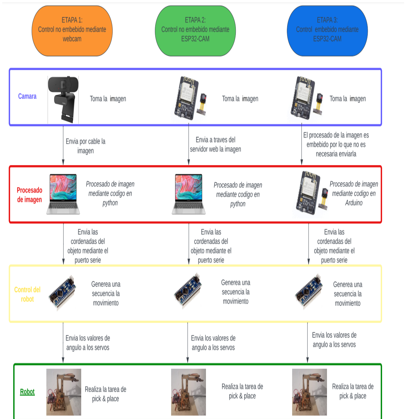
Figura 15. Esquema de etapas. muestra los componentes que forman cada una de ellos así como la relación entre los mismos
