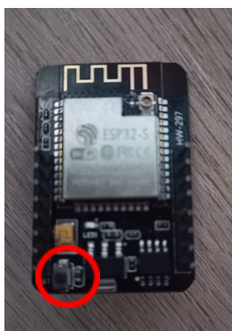
Figura 42. Imagen para la identificación del botón de reset en la ESP 32 - CAM
