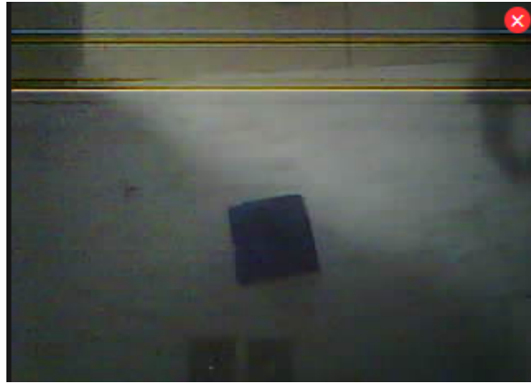
Figura 37. Imagen real tomada por la ESP32-CAM, que permite hacer visible el problema de ruido estático que sufre la cámara.
