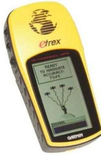
Imagen 4. Modelo de navegador GPS, GARMIN eTrex.
