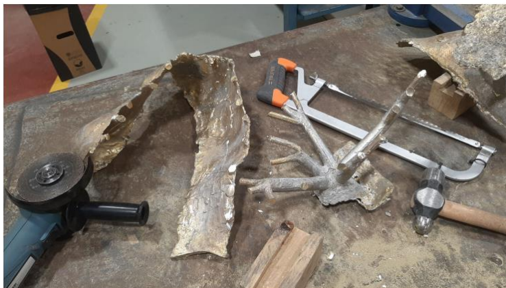
Fig. 83 Estela Ferrer, Deconstrucción , 2022. Corte de los árboles de colada.
