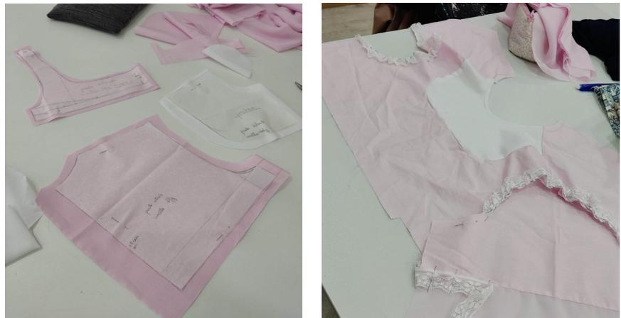
Fig.26. Imágenes del proceso de corte en tela del patrón y montaje de la misma pieza.
