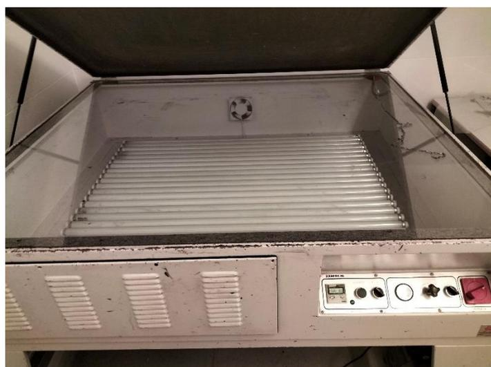
Ponemos la pantalla encima de los fotolitos, colocamos la cadenita por el marco y bajamos la mantilla, cerrando con el seguro. Giramos el botón de vacío, esperamos a que llegue a 40 bar, presionamos el botón de exposición (luz
