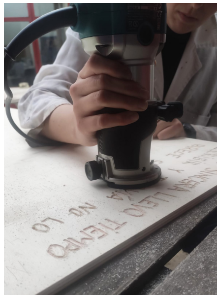
Fig. 84. Proceso de fresado sobre la madera
