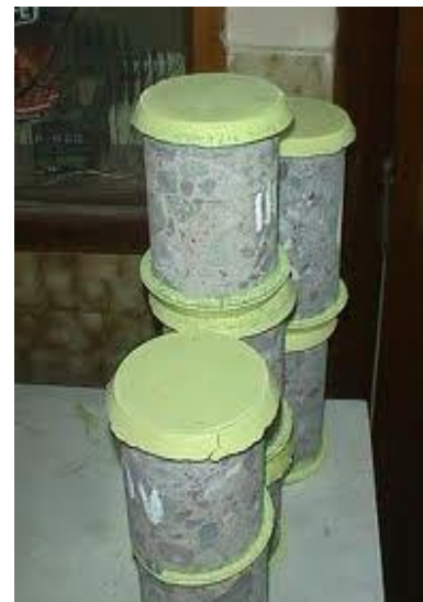
Imagen 16: Probeta tras el Proceso de Ajuste de muestras Fuente: Elaboración propia
