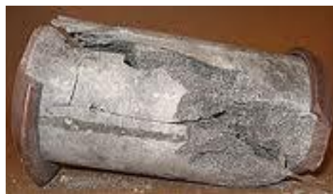
Imagen 17: Probeta de Ensayo tras el Proceso de Rotura Fuente: Elaboración propia
