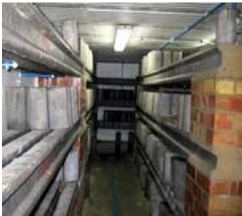
Imagen 14: Probetas en Proceso de Curado en Cámara Fuente: Elaboración propia
