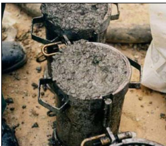
Imagen 11: Probeta de Ensayo recogida en Obra Fuente: Elaboración propia
