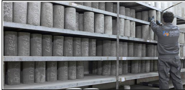
Imagen 12: Probetas marcadas en Cámara Frigorífica Fuente: Elaboración propia
