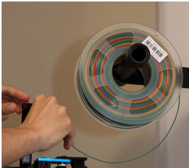
Fig. 35. Cambio de filamento. PLA multicolor, 2022.
