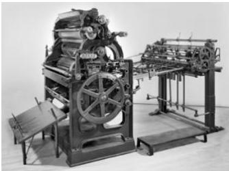
Figura 6. Impresora litográfica offset de Rubel
