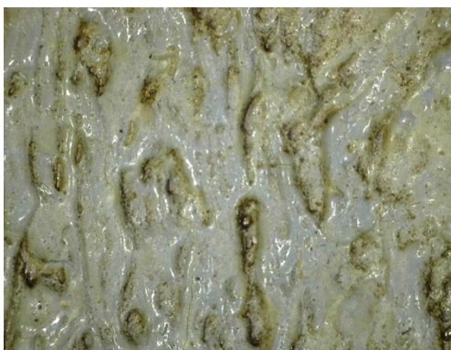
Figura 48. Detall de l'acumulació de vernís (augment x55).
