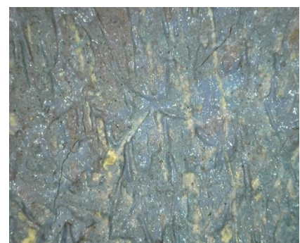
Figura 31. Detall de zona amb poca càrrega de pintura (augment x55).
