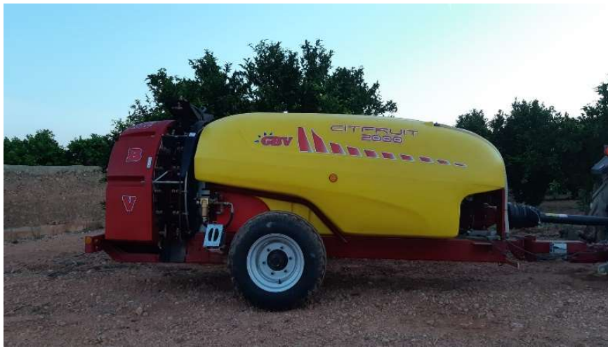
Figura 26 Pulverizador hidroneumático Citfruit 2000 empleado en el ensayo experimental
