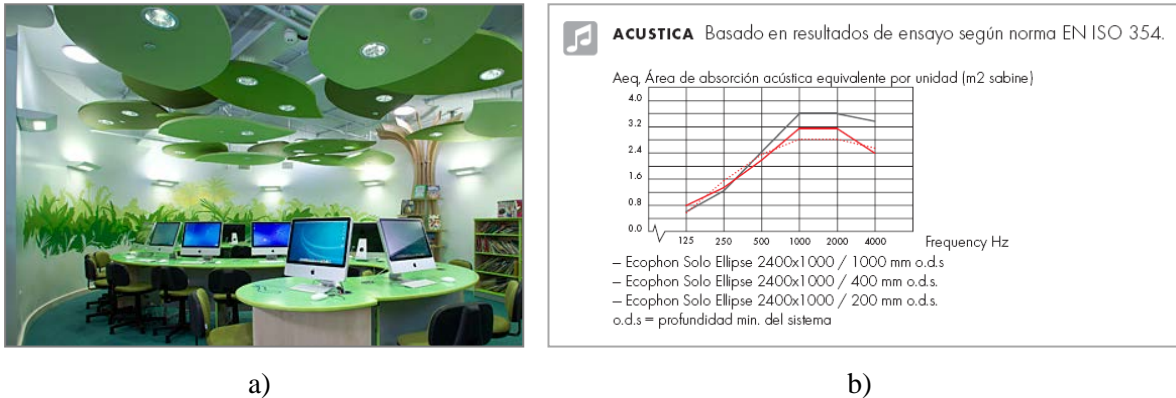
Fig. 3. Falsos techos. a) Fotografía modelo Ecophon Solo. b) Área de absorción acústica equivalente por unidad del modelo Ecophon.
