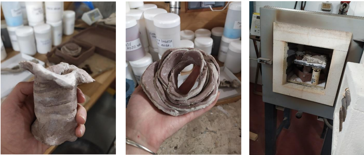
Fig 106, 107, 108. Pruebas con gres de alta temperatura después del cocido
