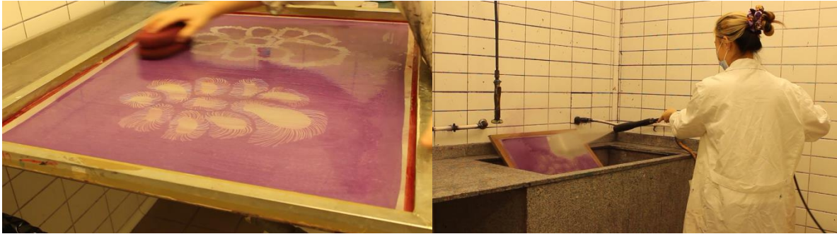
Fig 55 y 56. Proceso de recuperación de la pantalla serigráfica
