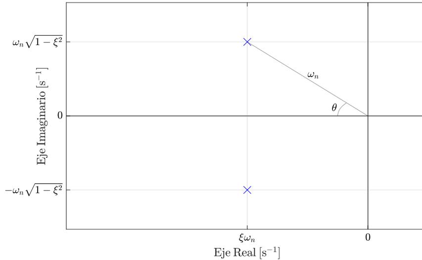
**Figura 1:** Representación en el plano complejo de los polos de un sistema dinámico de segundo orden.
