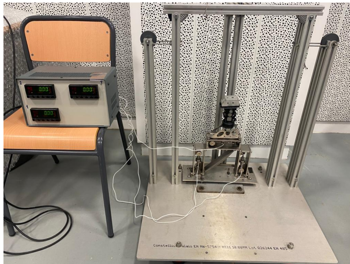
Figura 63: Sistema de calibración de la balanza.
