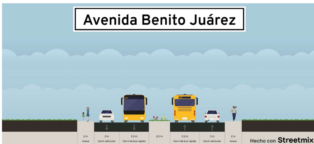
Figura 19. Sección tipo propuesta Avenida Benito Juárez PK 2+000 (Elaboración propia).
