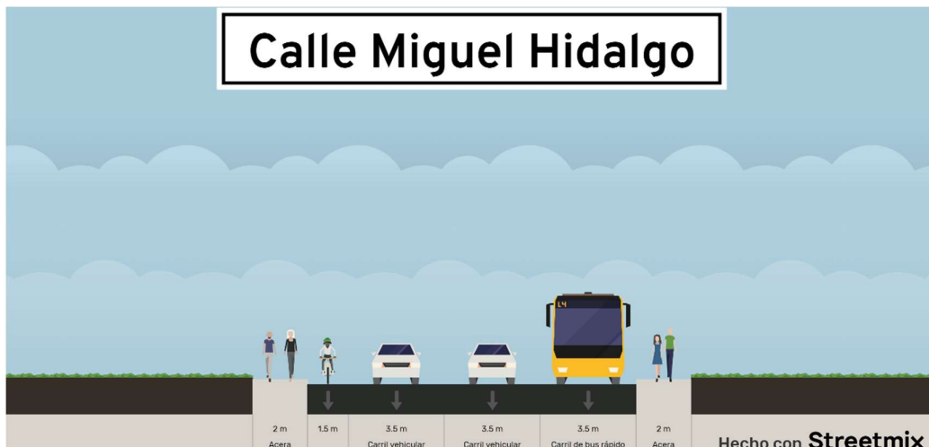
Figura 12. Sección tipo propuesta Calle Miguel Hidalgo PK 7+700 (Elaboración propia).
