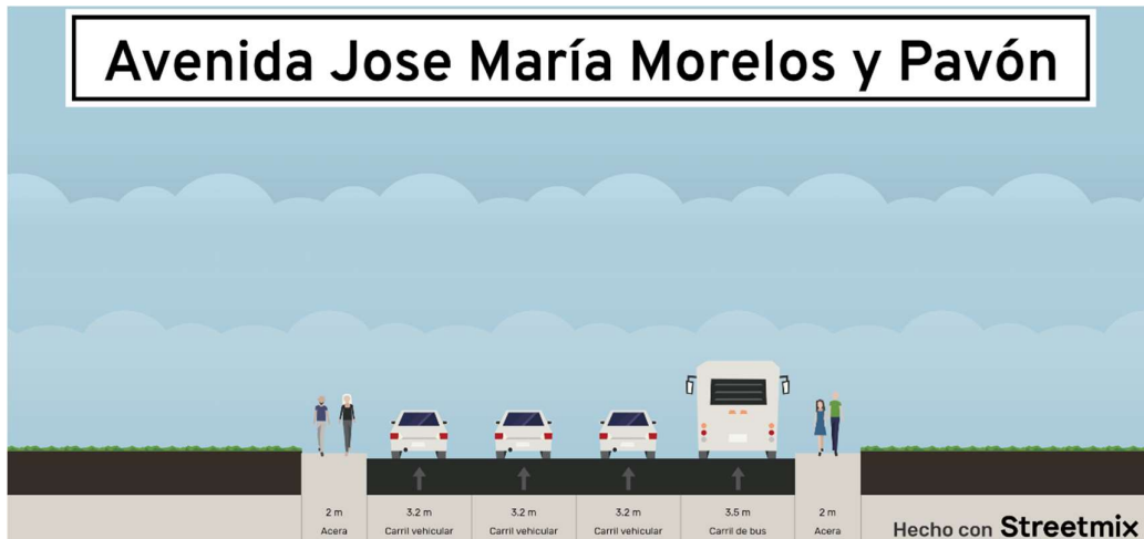
Figura 9. Sección tipo actual Avenida Jose María Morelos y Pavón PK 7+700 (Elaboración propia).
