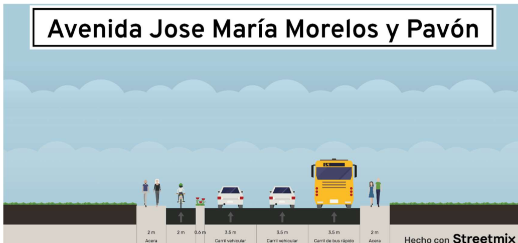
Figura 10. Sección tipo propuesta Avenida Jose María Morelos y Pavón PK 7+700 (Elaboración).
