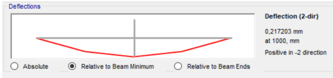
Imagen 39: Flecha máxima del tramo de 2000 mm de perfil perimetral más solicitado.
