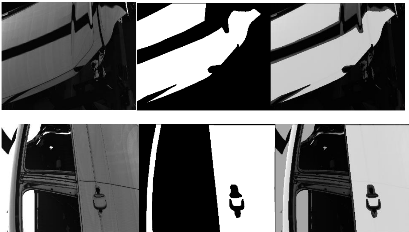
Figura 1. Fusió de diferències (esquerra), màscara (mig), superposició de la màscara a la fusió (dreta)
