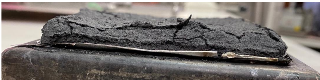
Figura I.6.2. Ejemplo de intumescencia tras ensayo de cono calorimétrico en PA con grafito expandido como aditivo.
