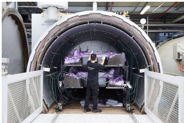
Imagen 129 Autoclave de Lamborghini donde se fabrican las piezas de fibra de carbono 61
