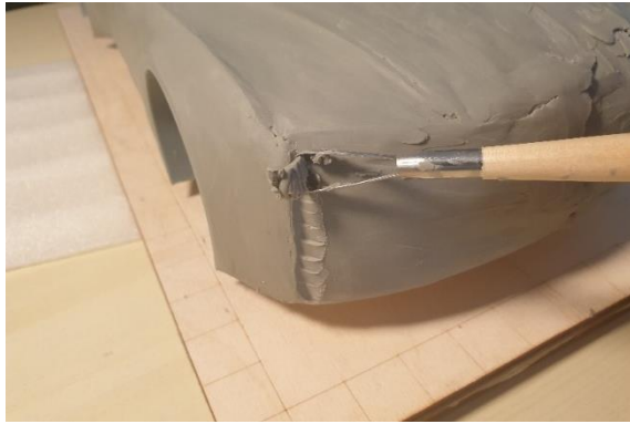
Imagen 81 Vaciado de la forma general
