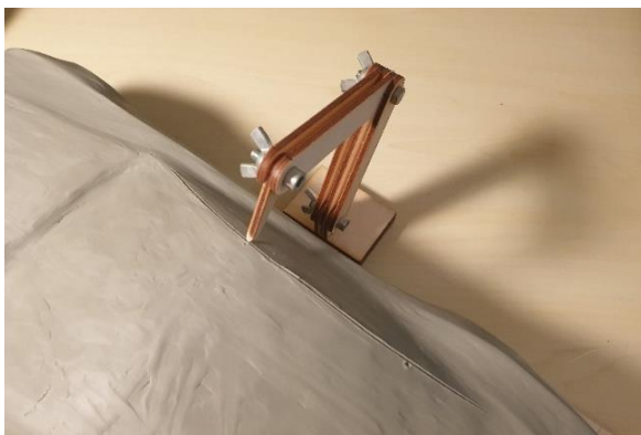
Imagen 75 Obtención de punto de referencia con el gramil
