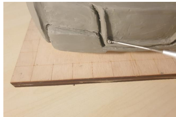
Imagen 89 Aplicación de plastilina con el punzón
