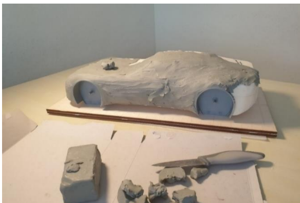
Imagen 70 Aplicación de la plastilina
