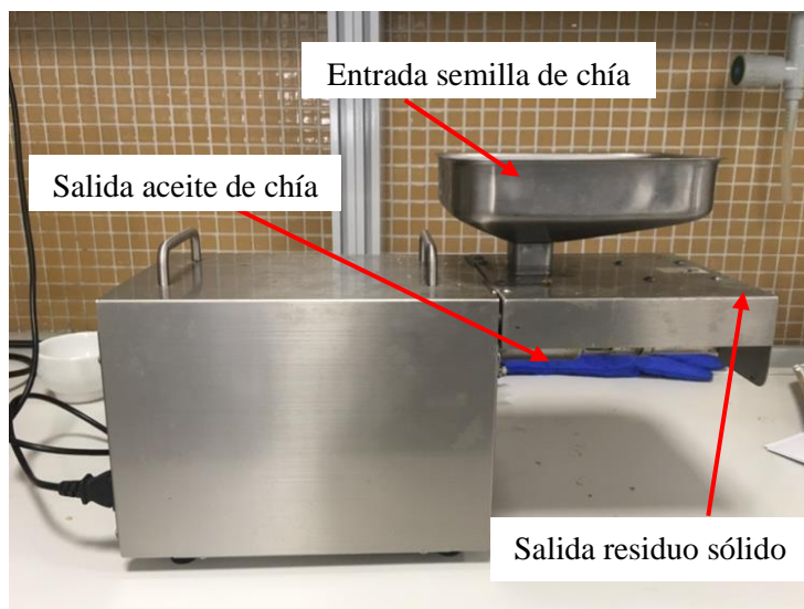
Figura 17. Partes de la extrusora de prensado en frío.
