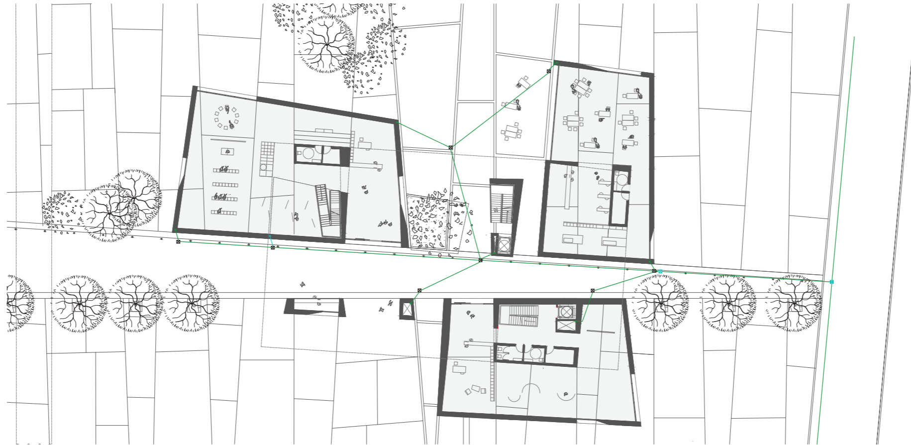
PLUVIALES_ PLANTA BAJA escala 1/500
