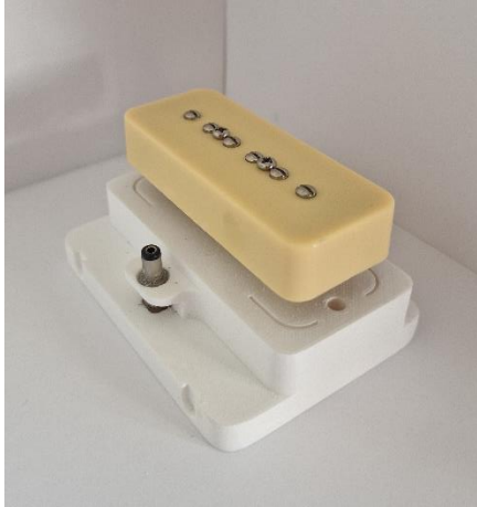
Il·lustració 45: Prototip amb pastilla P90
