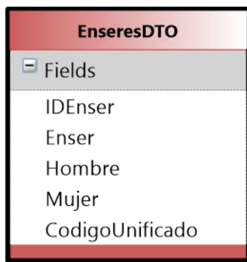
Figura 4.13: DTO modelado que representa la tabla Enseres y sus columnas
