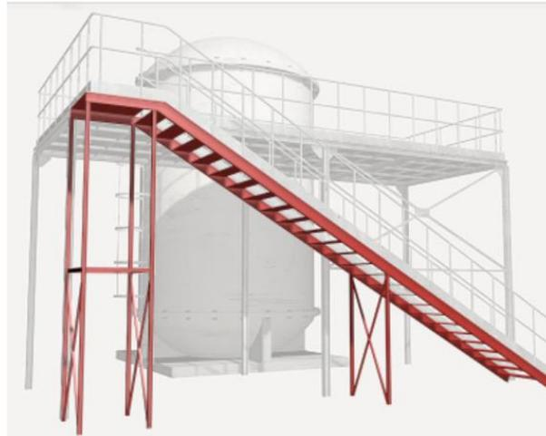
Ilustración 28. Escalera de acero. Fuente: Generador de Precios.
