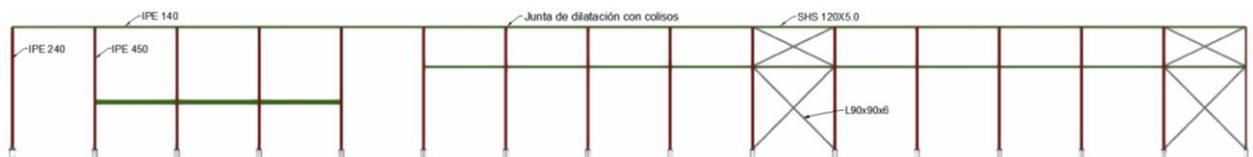
Ilustración 15. Fachada lateral, alineación 3.
