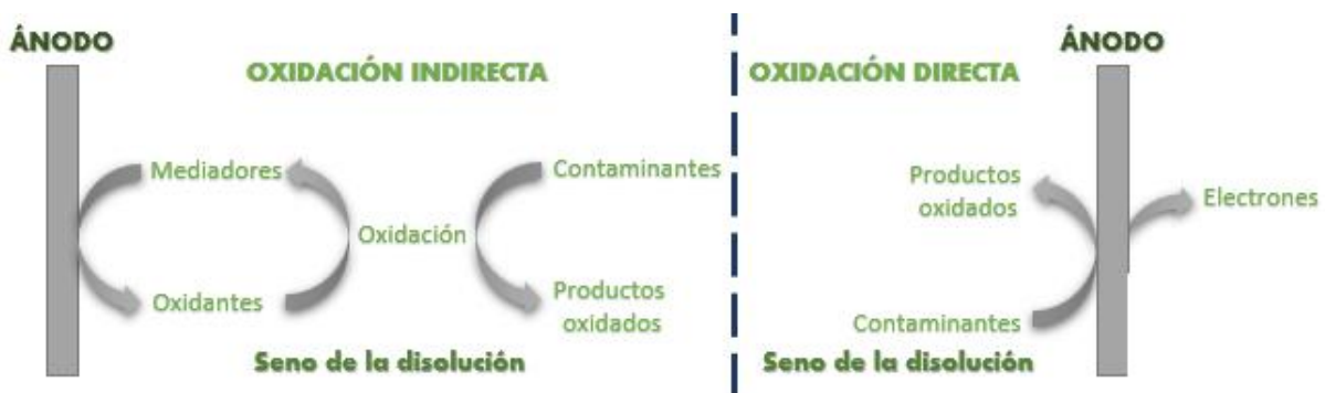
Figura 5. Mecanismos de reacción en la oxidación anódica. Adaptado de [62].
