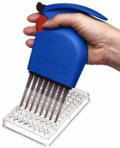
Figura 9: Dispositivo PickPen™ y placa de resuspensión. Los botones rojo y negro permiten poner los imanes para la inmunocaptura y quitarlos para soltar los complejos perla-objetivo (MERCK, 2022a)
