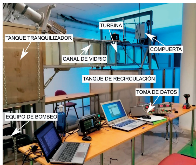
Figura 5 | Túnel hidrodinámico de la EPM de la Universidad de Oviedo.
