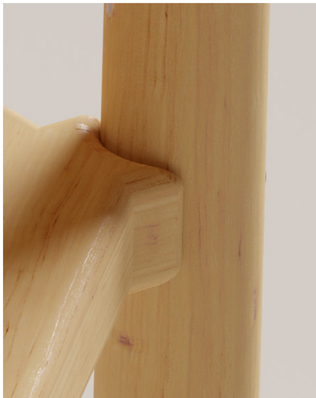
Figura 106. Rónder detalle unión estructura estante con las patas. (Elaboración propia, 2022).
