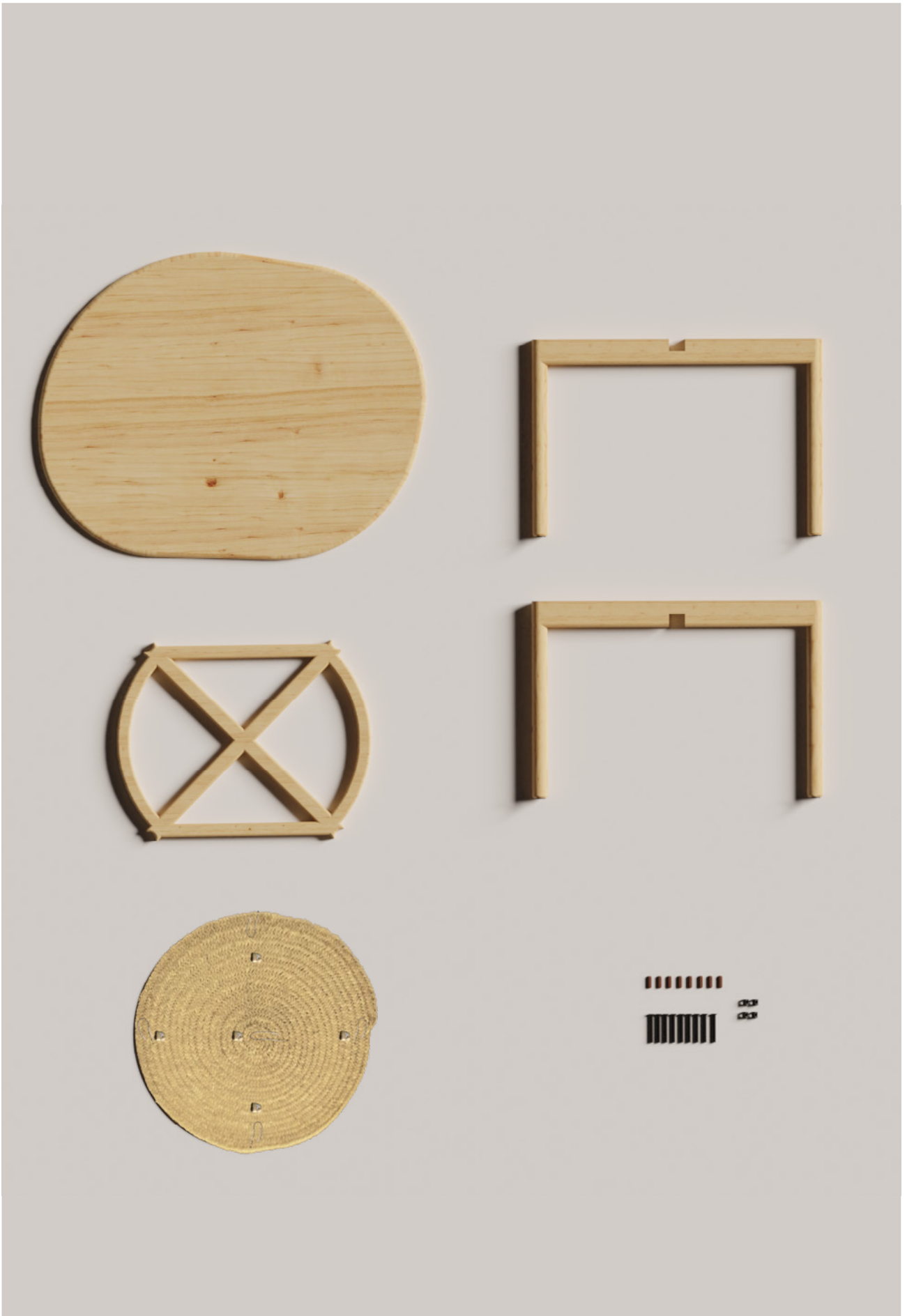
Figura 100. Rénder de los diferentes componentes y herrajes de la mesa. (Elaboración propia, 2022).
