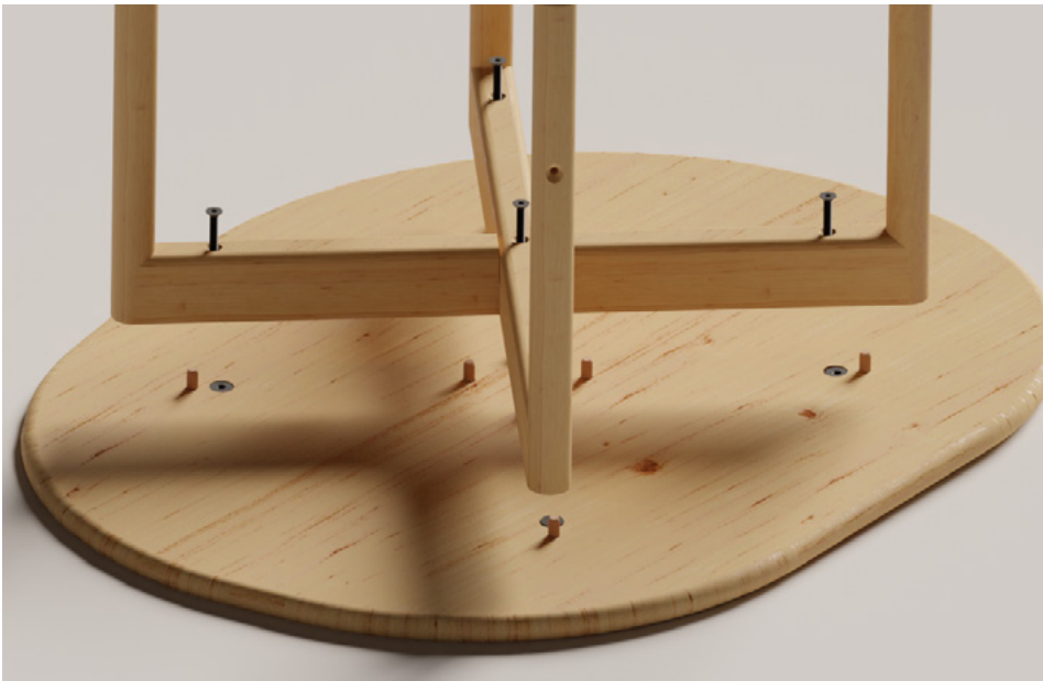
Figura 115. Rénder detalle de la unión entre patas y sobre. (Elaboración propia, 2022).
