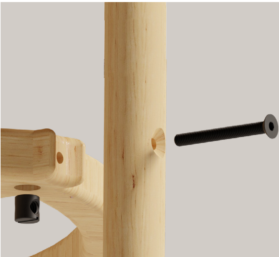
Figura 116. Rénder detalle de la unión entre patas y estructura estante. (Elaboración propia, 2022).
