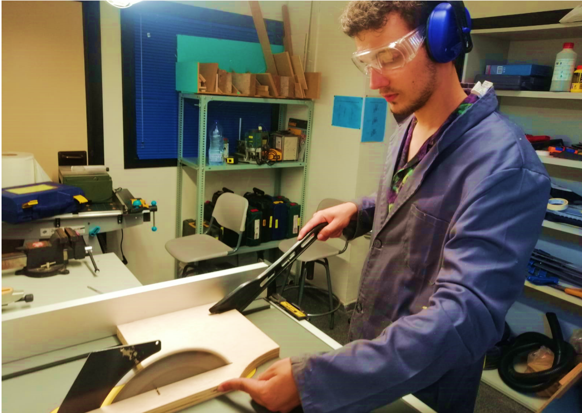
Figura 31: Procés del tall d'una de les parts que conformen l'altaveu
