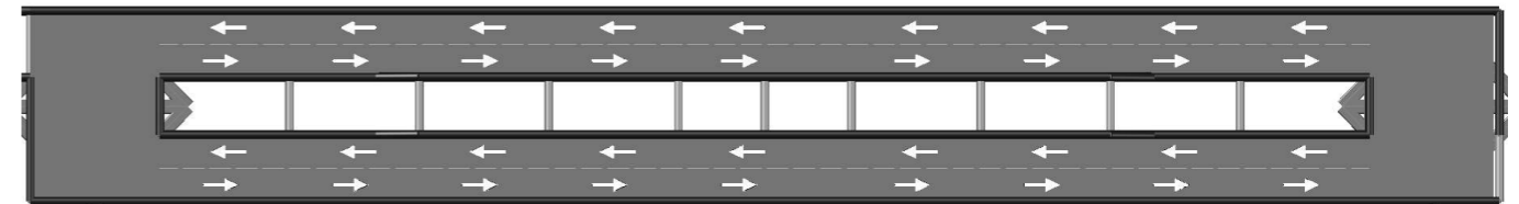
Figura 10. Señales pintadas sobre el pavimento del tablero. Fuente: elaboración propia AutoCAD
