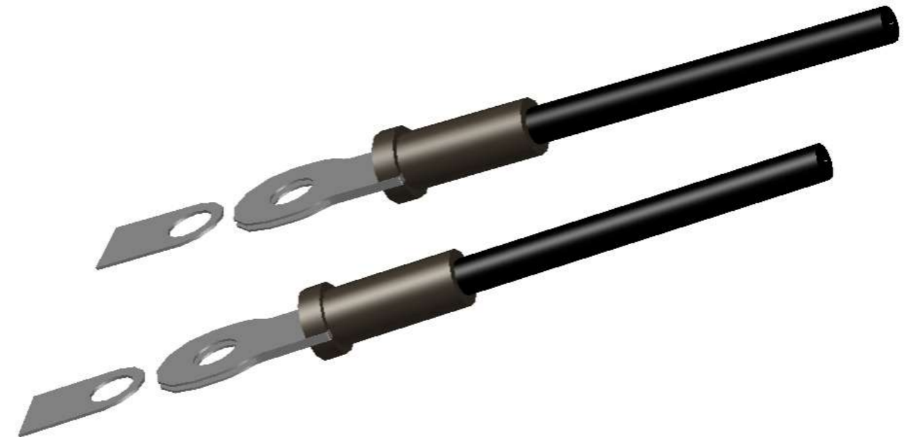
Figura 14. Esquema de las cartelas y anclajes de los tirantes. Fuente: elaboración propia AutoCAD.
