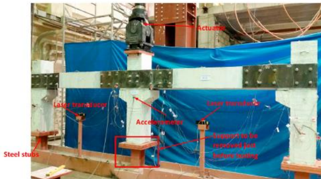
Figura 18. Espécimen de ensayo del refuerzo de nudos en pórtico de hormigón armado con placas metálicas [17].
