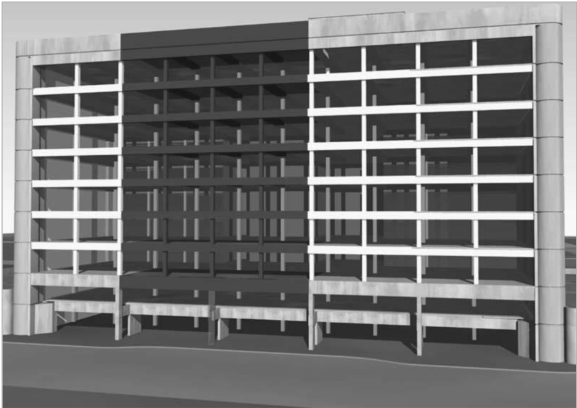
Figura 23. Modelo que señala la afección de la pérdida de G20 a los forjados en la fachada norte [27].
