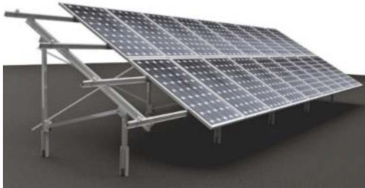
Imagen 17. Soporte inclinado a 35° para dos filas de paneles- Hincado vertical SUNFER
