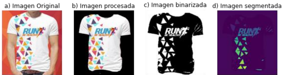
Figura 20. Procesamiento de la imagen. En la figura a) se observa la imagen original, en la b) se ha aplicado la técnica de Background Subtraction. La imagen c) contiene la camiseta únicamente en blanco y negro, mientras que la imagen d) muestra la imagen ya segmentada en regiones y etiquetada. Fuente: elaboración propia
