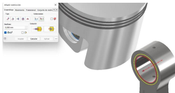
Figura 6.12 Ensamble entre el pistón y la biela
