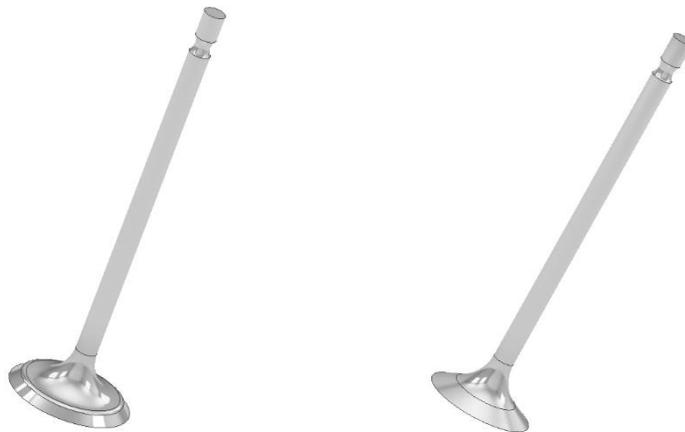
Figura 5.49 Aspecto final de la válvula de admisión (izquierda) y escape (derecha)
