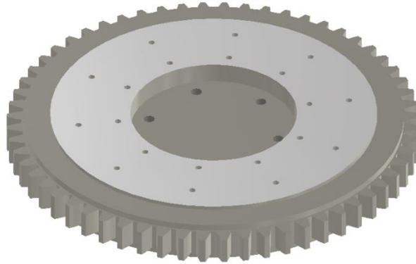
*Figura 5.75 Aspecto final del volante de inercia*
