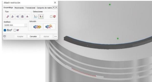
Figura 6.1 Inserción de los segmentos sobre el pistón
