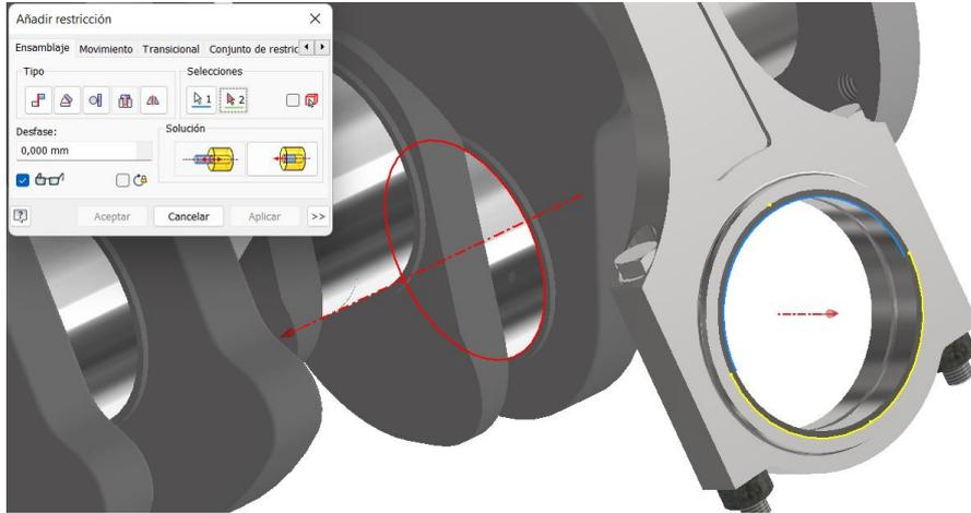
*Figura 6.13 Ensamble entre la biela y el cigüeñal*
