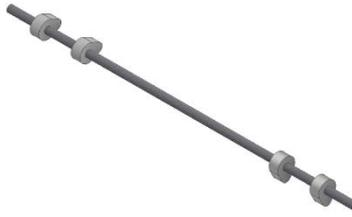
Figura 5.71 Diseño final del árbol de levas
