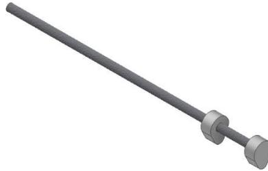
Figura 5.67 Levas de un cilindro y eje extrusionado
