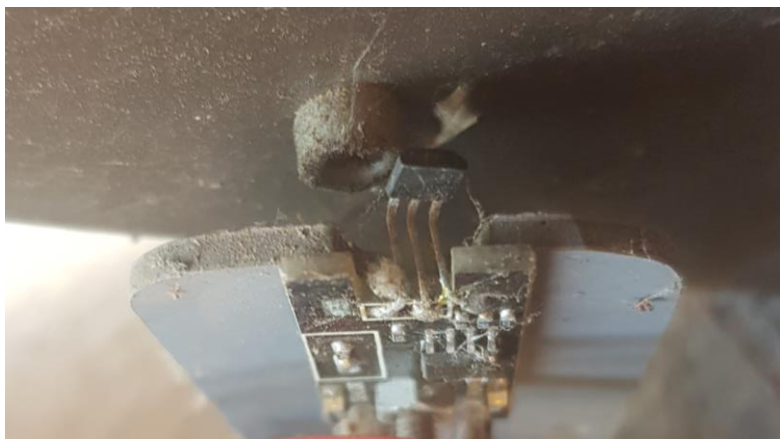
Figura 78 Posición del imán para el funcionamiento del sensor de efecto hall
