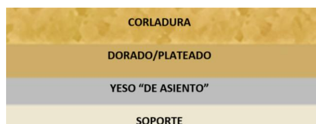
Fig.6: Esquema estratigráfico del proceso de corlar una superficie dorada.
