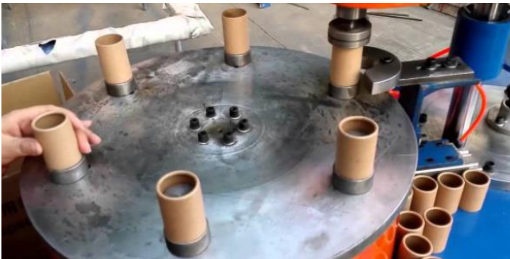
Fig. 147- Proceso de la moldeadora de tubos
