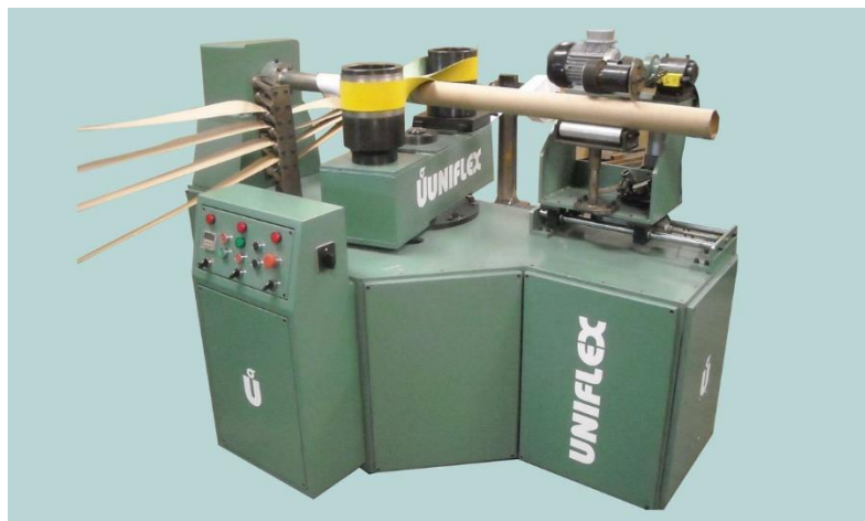
Fig. 148-Formadora de tubos de cartón UNIFLEX
