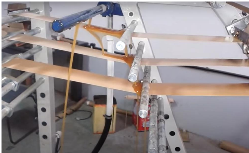
Fig. 142- Adición del adhesivo
