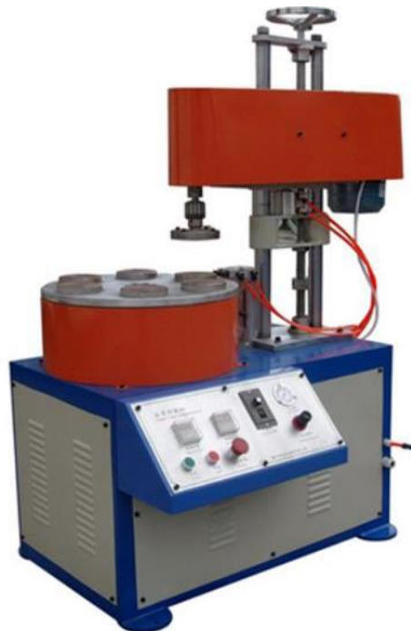
Fig. 151- Máquina moldeadora de tubos
