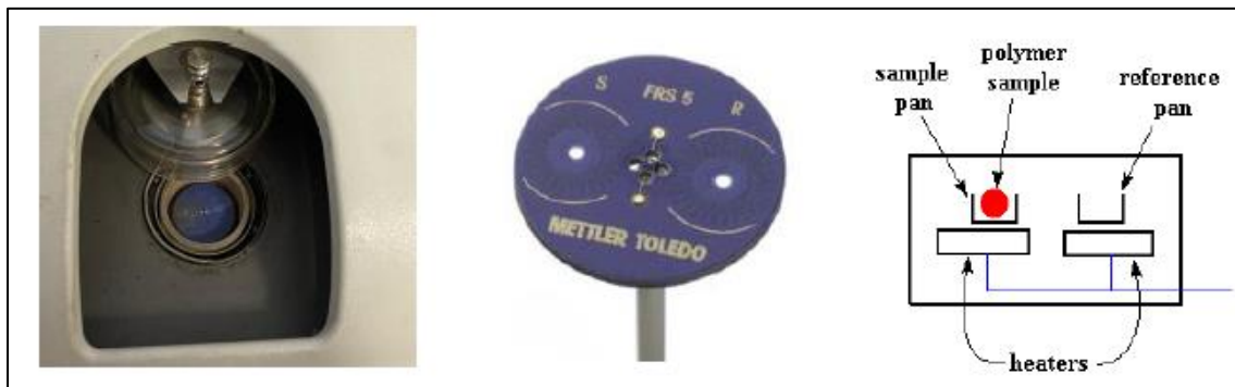
Figura 21. Cámara de calentamiento, calefactores y esquema de trabajo.
