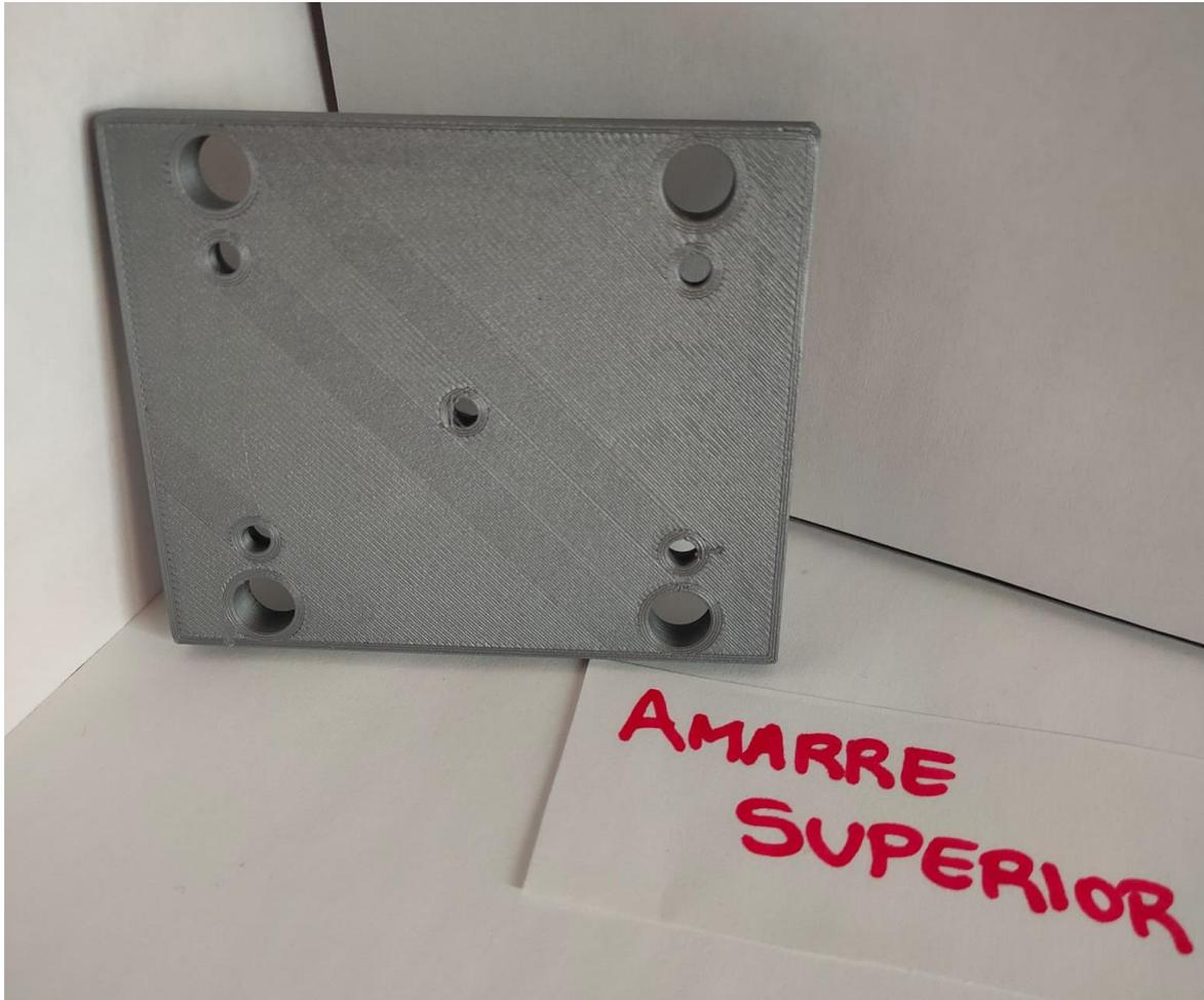
Esta es la placa de amarre superior y se caracteriza por ser la placa por la que entrará el plástico de la inyectora al molde. Se puede ver la cavidad para el BRB3 así como los agujeros para el disco centrador BRDC.
