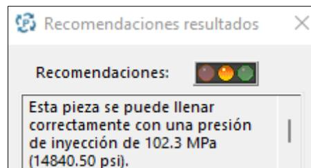
Figura 9. Recomendación de presión de inyección.
