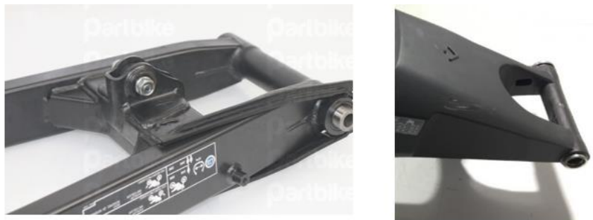
Figura 66. Ejes pasantes de un basculante de una Honda CBF 125 a la izquierda y una Yamaha YZF R125 a la derecha
