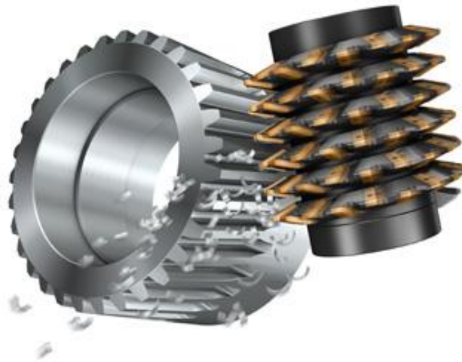
Ilustración 18. Imagen de una fresa cortando una rueda dentada.
