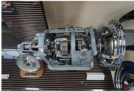
Ilustración 9. Primera caja de cinco velocidades.
