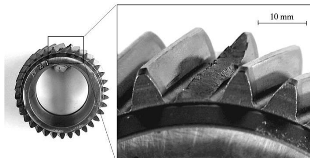
Ilustración 29. Imagen de un engranaje gripado.
