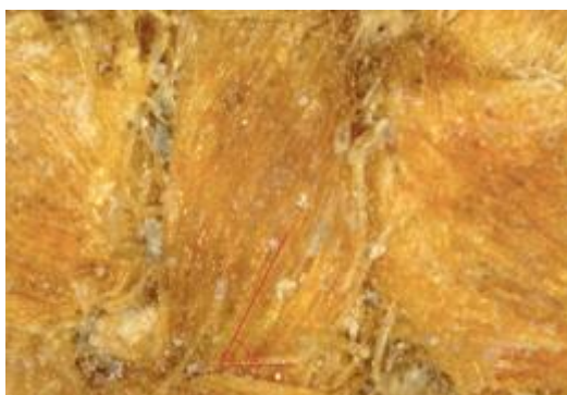
Fig. 24. Macrofotografía con ángulo de torsión del hilo. Realizada con Dino-lite® a 55X.
