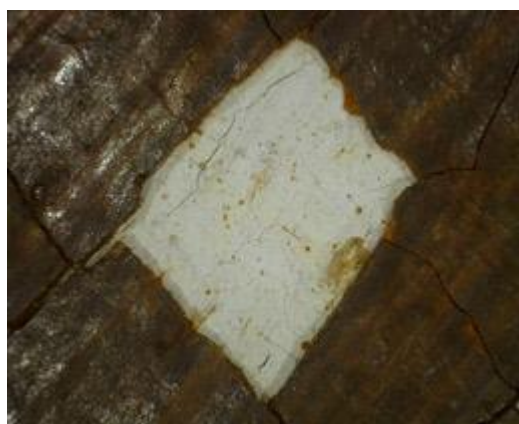
Fig. 55. Perdida puntual de la película pictórica. Dino-Lite®. 55X.
