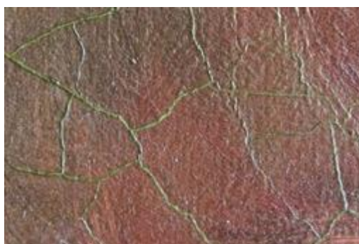
Fig. 58. Fotografía de las grietas prematuras en la zona del fondo.
