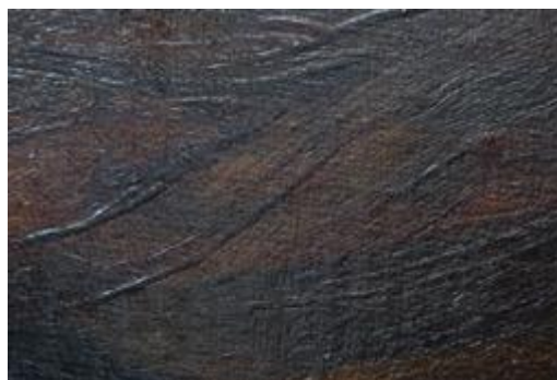
Fig. 58. Fotografía de las grietas prematuras en la zona del fondo.
