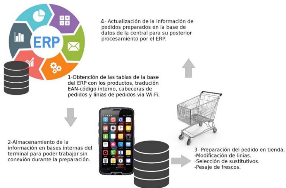
Ilustración 38: Esquema resumen del tráfico de datos desde la obtención de datos en el terminal hasta su posterior deposición en el ERP.
