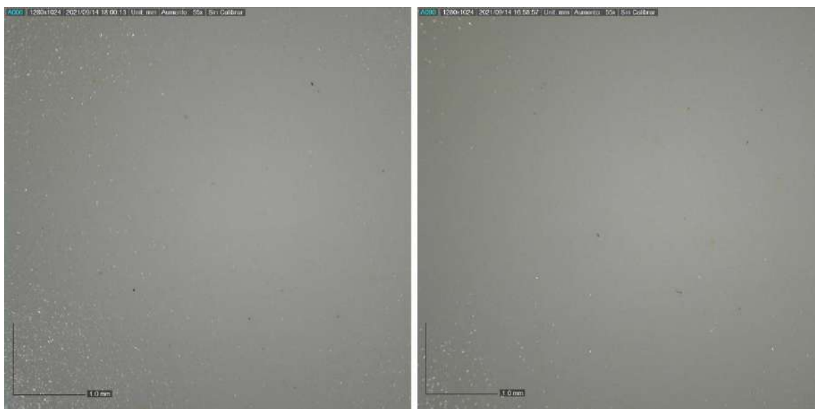
Figura 25. Detalle bajo microscopio con 55.0x aumentos de las piezas de ensayo de barniz Paraloid® B-72. A la izquierda, la probeta sin envejecimiento; a la derecha, la probeta tras su exposición a envejecimiento acelerado.
