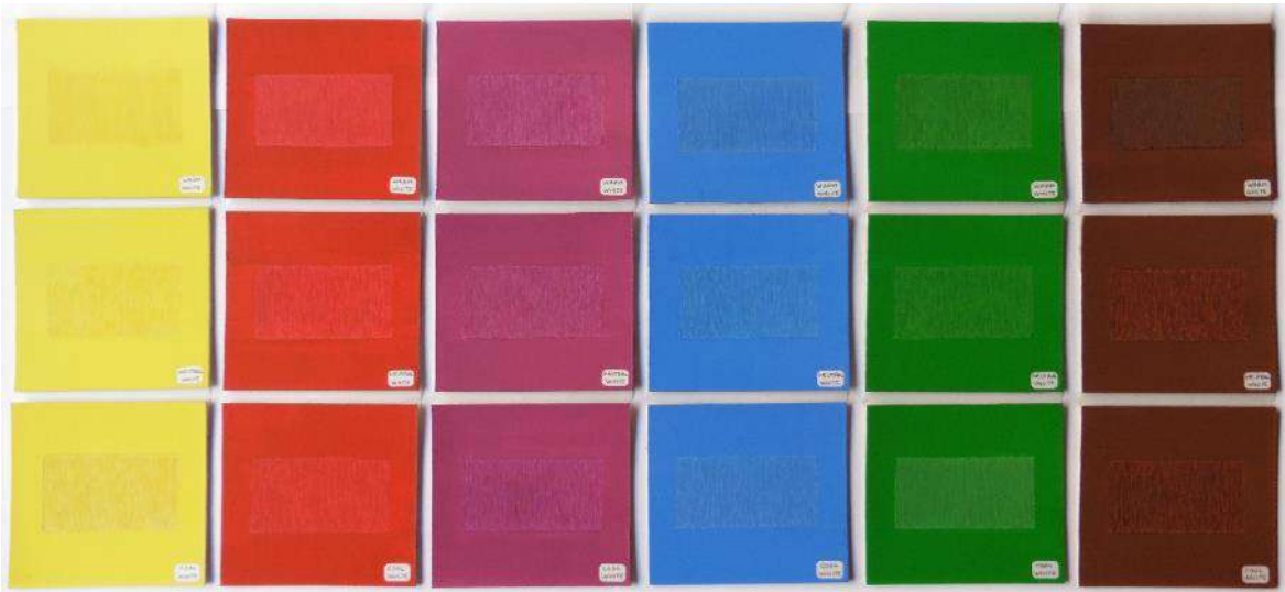
Figura 145. Resultados de la reintegración de las dieciocho probetas, correspondiendo la primera fila a las realizadas con iluminación cálida; la segunda fila a iluminación neutra; y la tercera fila a iluminación fría.
