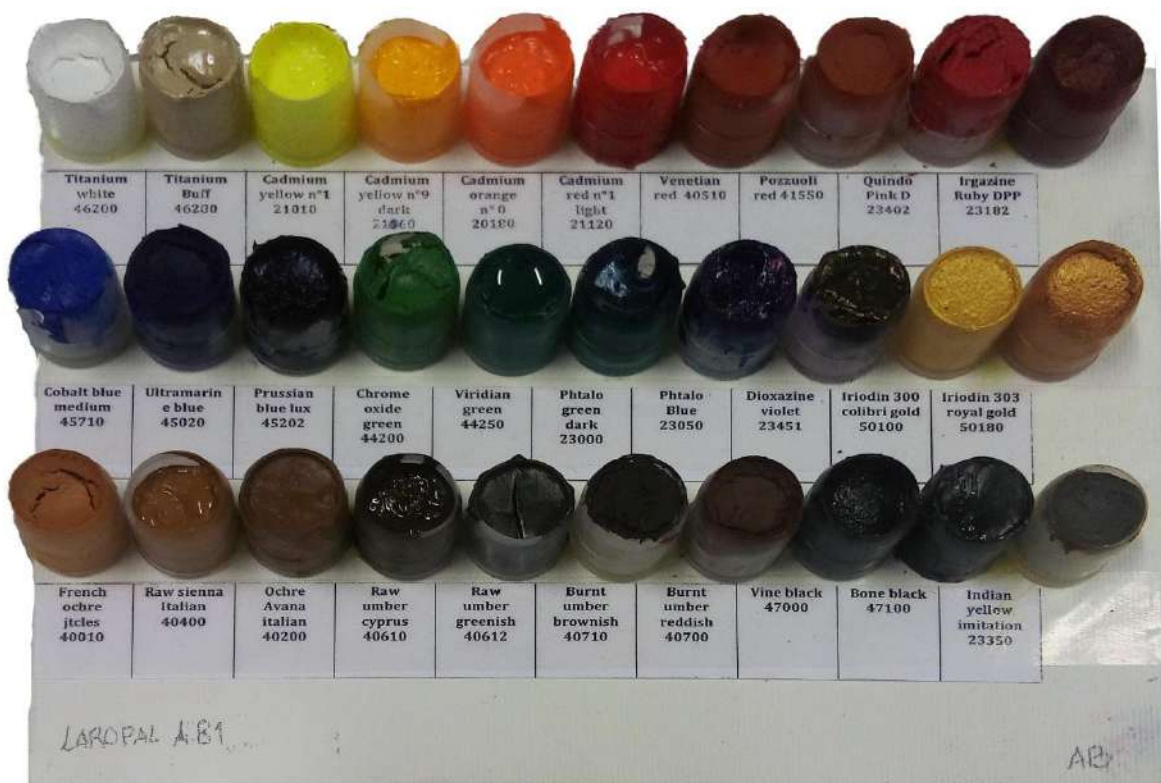
Figura 158. Pinturas para reintegración cromática elaboradas por la dra. Ana Bailão con pigmentos en polvo aglutinados con resina Laropal® A-81.
