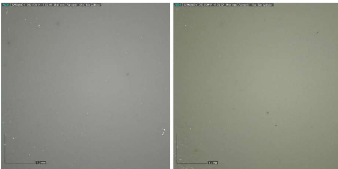
Figura 184. Detalle bajo microscopio con un aumento de 55.0x de las piezas de ensayo de barniz de Regalrez® 1094. A la izquierda, la probeta sin envejecimiento; a la derecha, la probeta tras su exposición a envejecimiento acelerado, en el cual se percibe un notable amarilleamiento de la resina sintética.
