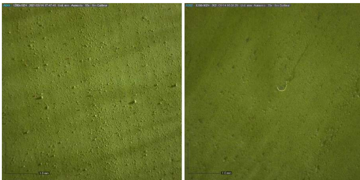
Figura 15. Detalle bajo microscopio con 55.0x aumentos de las piezas de ensayo de barniz dammar más pigmento verde óxido de cromo. A la izquierda, la probeta sin envejecimiento; a la derecha, la probeta tras su exposición a envejecimiento acelerado.
