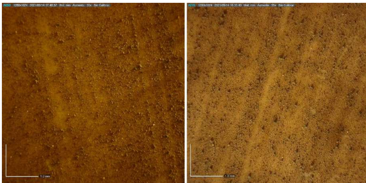
Figura 16. Detalle bajo microscopio con 55.0x aumentos de las piezas de ensayo de barniz dammar más pigmento sombra natural. A la izquierda, la probeta sin envejecimiento; a la derecha, la probeta tras su exposición a envejecimiento acelerado.
