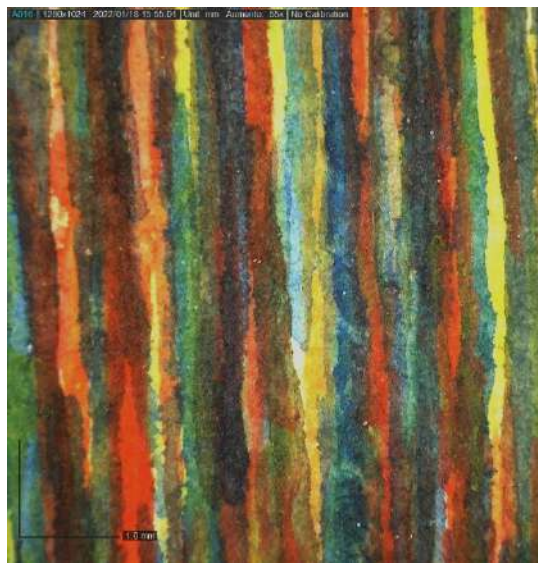
Figura 118. Detalle bajo microscopio con 55.0x aumentos de la probeta 1-B en la que se comprueba la notable reducción espacios carentes de pintura gracias a la aplicación previa de una aguada de tinta.
