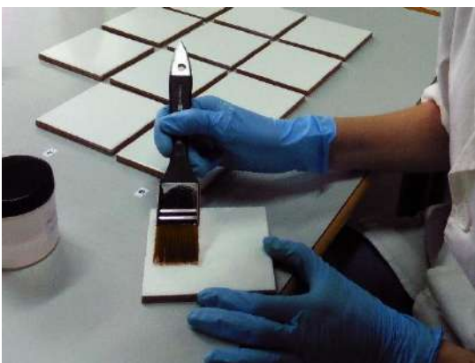
Figura 178. Detalle del proceso de aplicación de los barnices sobre los azulejos.
