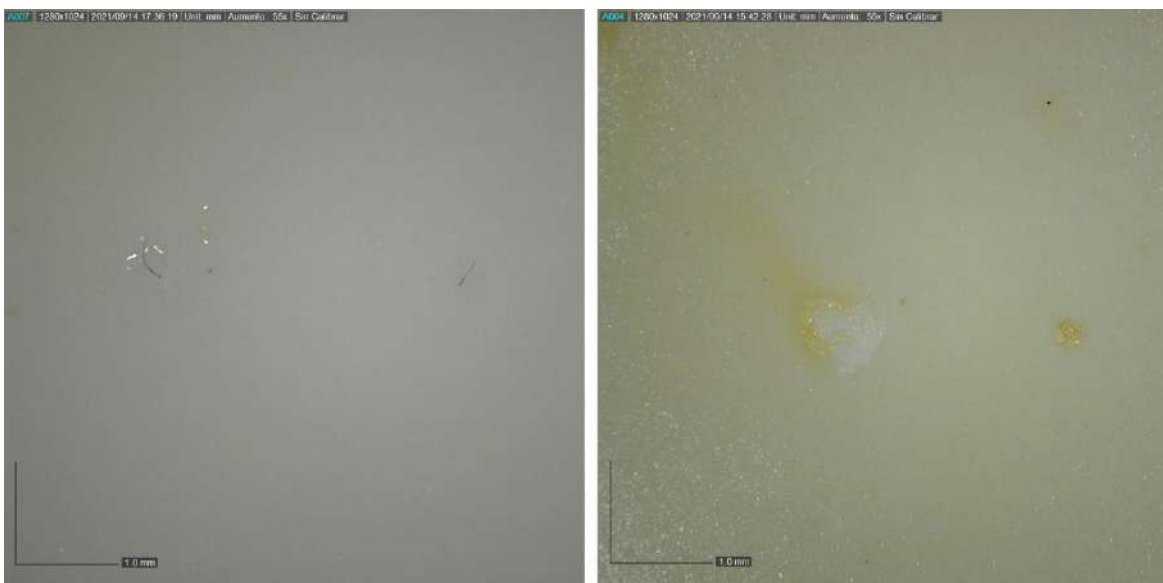
Figura 1. Detalle bajo microscopio con 55.0x aumentos de las piezas de ensayo de barniz de almaciga. A la izquierda, la probeta sin envejecimiento; a la derecha, la probeta tras su exposición a envejecimiento acelerado.
