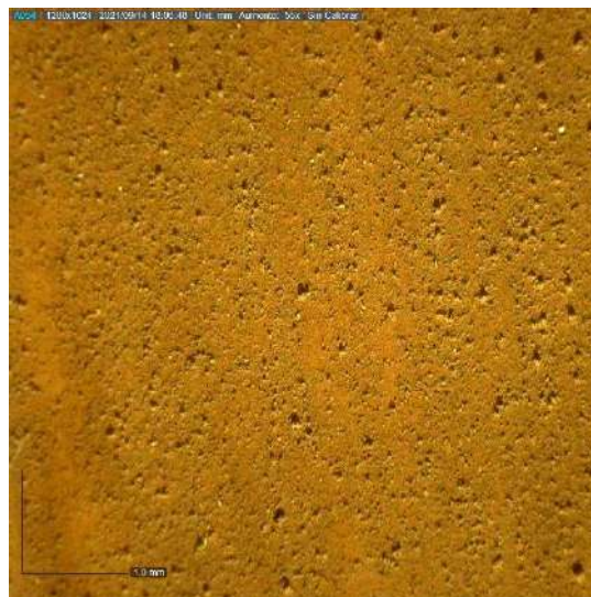
Figura 188. Detalle bajo microscopio con un aumento de 55.0x de la probeta de pintura elaborada con pigmento sombra natural y barniz Paraloid® B-72.
