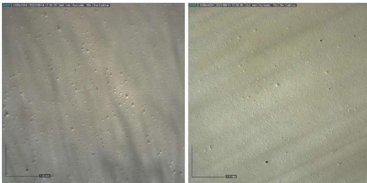
Figura 2. Detalle bajo microscopio con 55.0x aumentos de las piezas de ensayo de barniz de almáciga más pigmento blanco de titanio. A la izquierda, la probeta sin envejecimiento; a la derecha, la probeta tras su exposición a envejecimiento acelerado.
