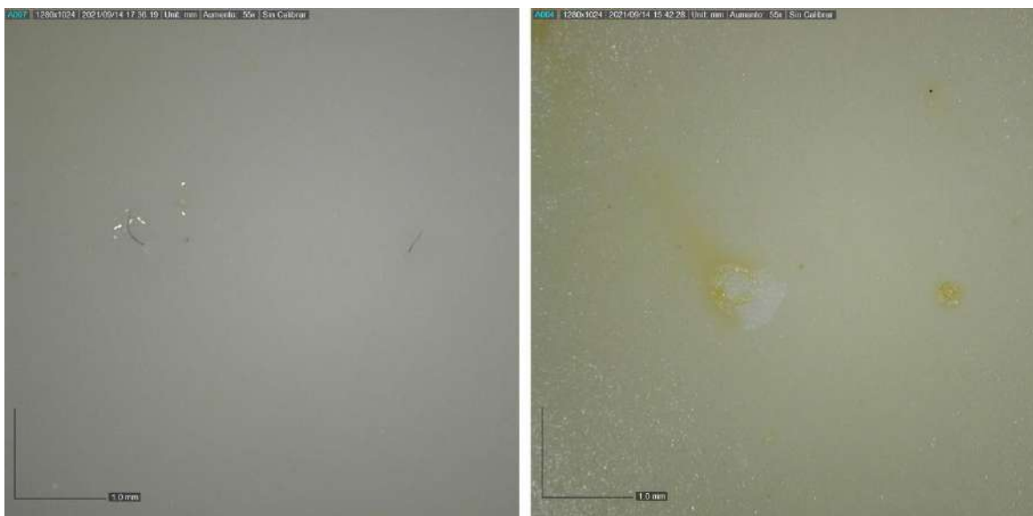
Figura 183. Detalle bajo microscopio con un aumento de 55.0x de las piezas de ensayo de barniz de almáciga. A la izquierda, la probeta sin envejecimiento; a la derecha, la probeta tras su exposición a envejecimiento acelerado, en el cual se percibe un notable amarilleamiento de la resina natural.
