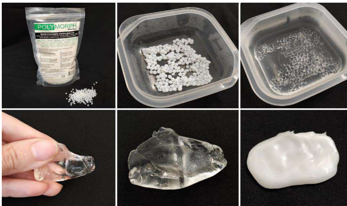
Figura 106. Secuencia de la preparación y solidificación del Polymorph®.
