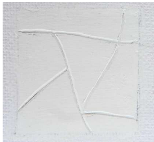
Figura 108. Ensayo de estuco comercial texturizado mediante la reproducción de una red de grietas.
