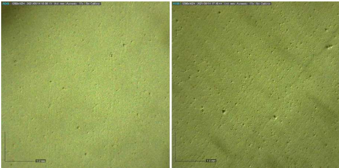
Figura 31. Detalle bajo microscopio con 55.0x aumentos de las piezas de ensayo de barniz Paraloid® B-72 más pigmento verde óxido de cromo. A la izquierda, la probeta sin envejecimiento; a la derecha, la probeta tras su exposición a envejecimiento acelerado.
