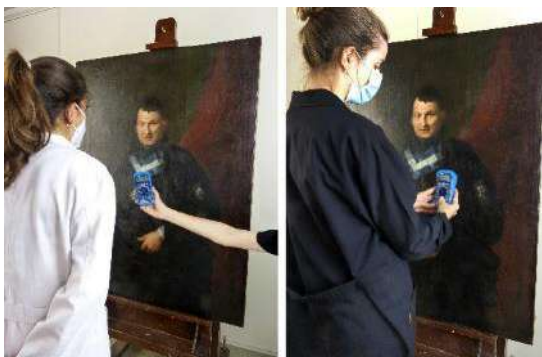
Figura 126. Toma de mediciones luminotécnicas en la obra Retrato del Canónigo Liñán , vistiendo una bata de taller blanca y una negra respectivamente.
