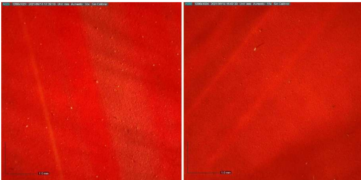
Figura 5. Detalle bajo microscopio con 55.0x aumentos de las piezas de ensayo de barniz de almáciga más pigmento rojo de cadmio n°2. A la izquierda, la probeta sin envejecimiento; a la derecha, la probeta tras su exposición a envejecimiento acelerado.
