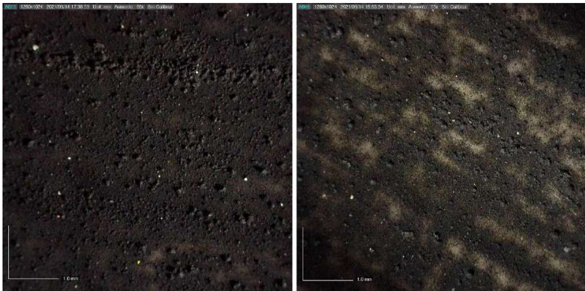
Figura 19. Detalle bajo microscopio con 55.0x aumentos de las piezas de ensayo de barniz Regalrez® 1094 más pigmento negro marfil. A la izquierda, la probeta sin envejecimiento; a la derecha, la probeta tras su exposición a envejecimiento acelerado.
