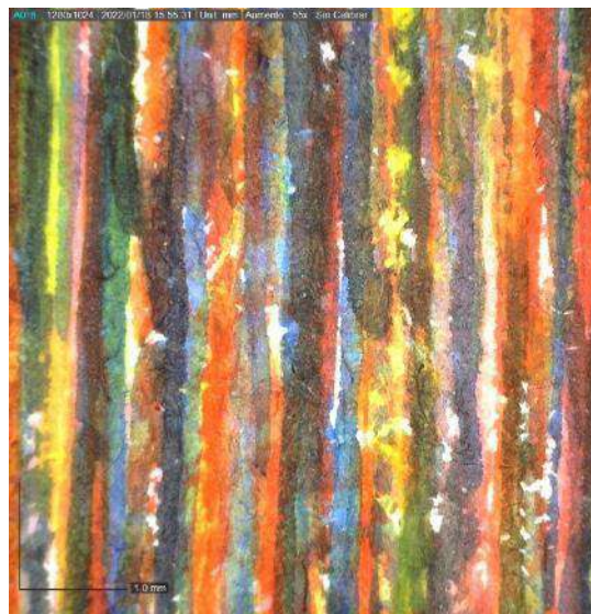
Figura 110. Detalle bajo microscopio con 55.0x aumentos de la probeta 1-A en la que se aprecian los espacios carentes de pintura.
