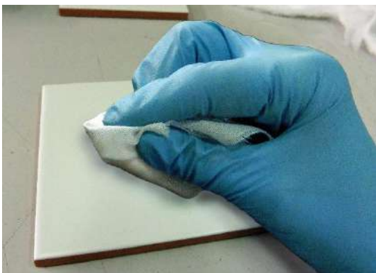
Figura 177. Detalle del proceso de limpieza y desengrasado de los azulejos con una muñequilla humedecida con etanol.
