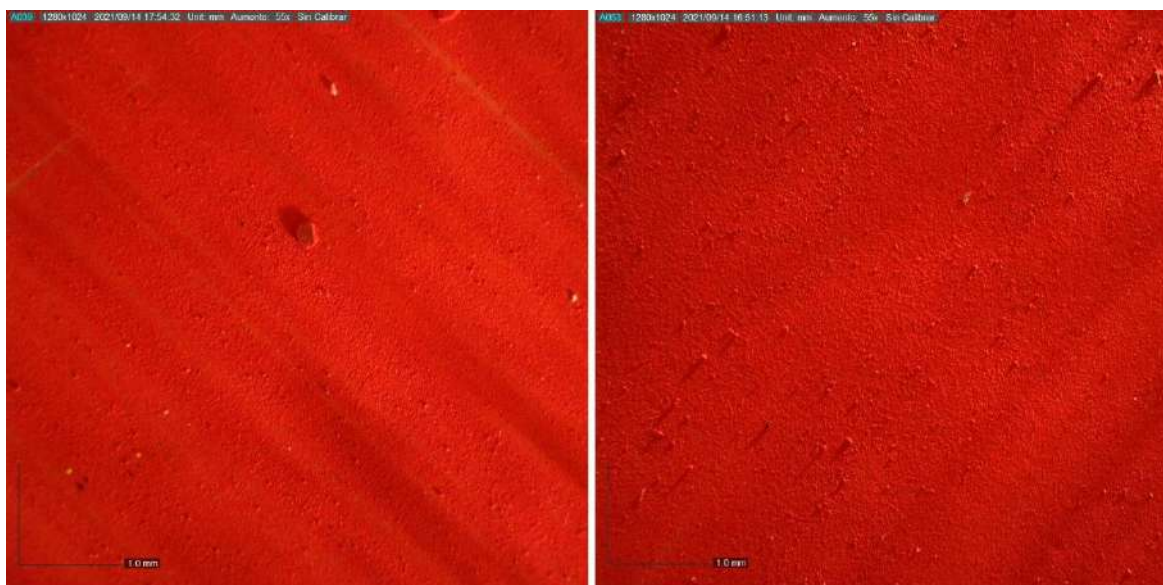
Figura 21. Detalle bajo microscopio con 55.0x aumentos de las piezas de ensayo de barniz Regalrez® 1094 más pigmento rojo de cadmio nº2. A la izquierda, la probeta sin envejecimiento; a la derecha, la probeta tras su exposición a envejecimiento acelerado.
