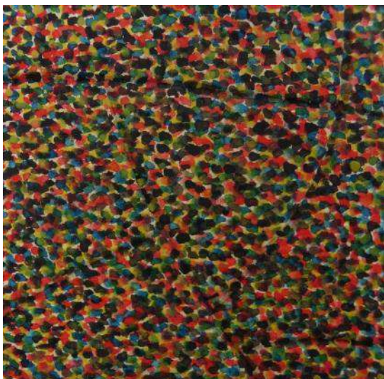
Figura 123. Detalle de la probeta 4-B, caracterizada por la aplicación previa de una aguada de tinta más la reintegración discernible con puntillismo en el estuco texturizado mediante la reproducción de una red de grietas.
