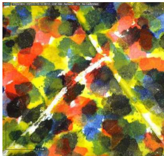
Figura 116. Detalle bajo microscopio con 55.0x aumentos de la probeta 4-A en la que se aprecian espacios carentes de pintura en la profundidad de las propias grietas.
