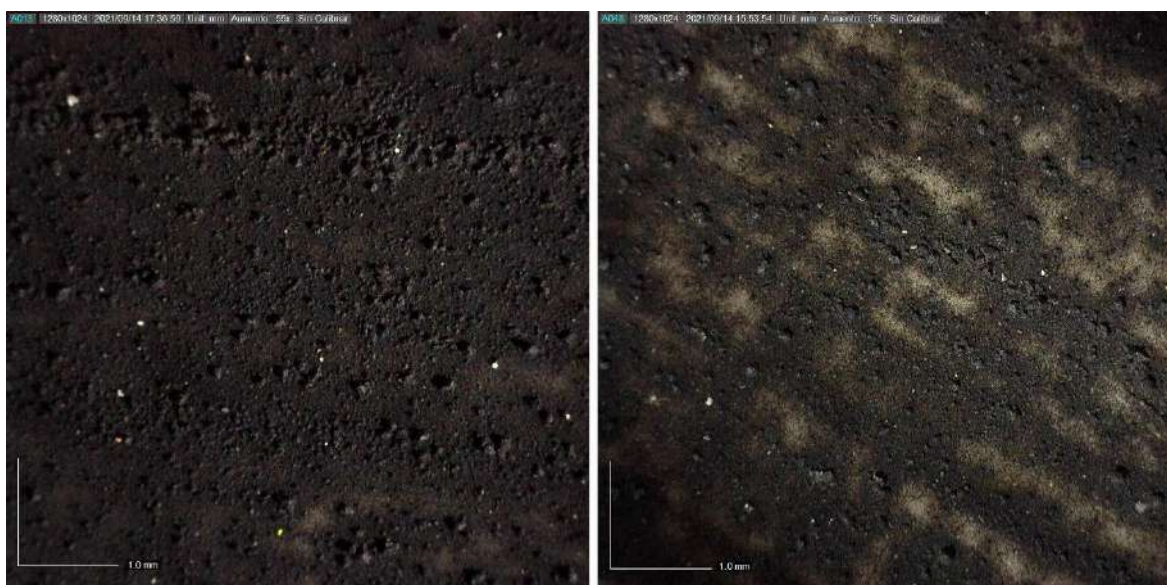
Figura 3. Detalle bajo microscopio con 55.0x aumentos de las piezas de ensayo de barniz de almáciga más pigmento negro marfil. A la izquierda, la probeta sin envejecimiento; a la derecha, la probeta tras su exposición a envejecimiento acelerado.
