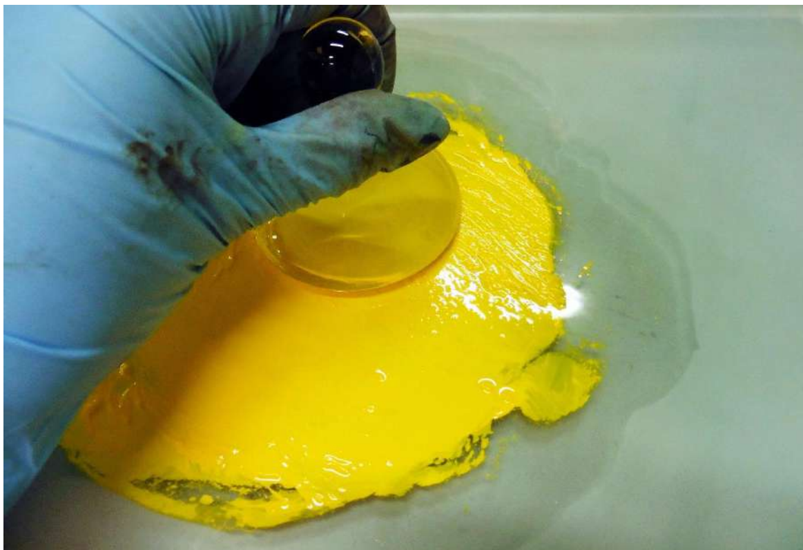
Figura 182. Detalle del proceso de molienda y englobe del pigmento amarillo de cadmio nº 6 con el barniz Laropal® A-81. En la imagen se aprecia cómo los componentes se quedan separados en dos fases sin dar lugar a una mezcla consistente y homogénea que pueda ser utilizada.
