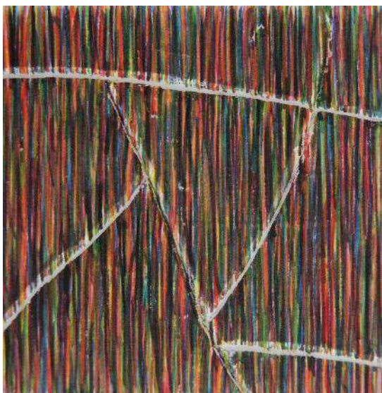
Figura 111. Detalle de la probeta 2-A, caracterizada por reintegración discernible con tratteggio en el estuco texturizado mediante la reproducción de una red de grietas.
