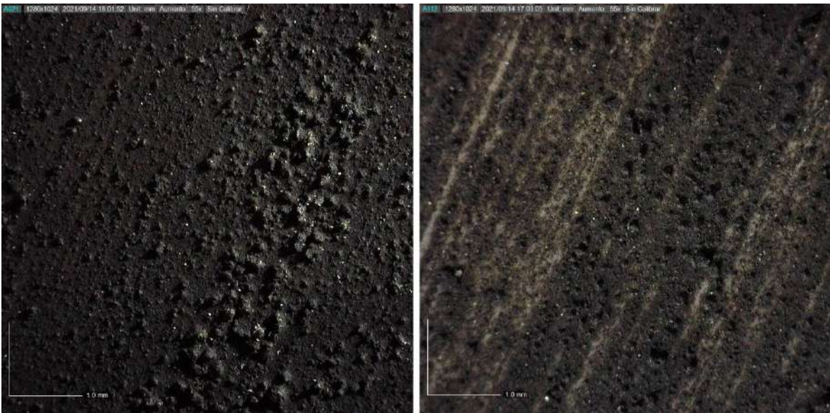
Figura 27. Detalle bajo microscopio con 55.0x aumentos de las piezas de ensayo de barniz Paraloid® B-72 más pigmento negro marfil. A la izquierda, la probeta sin envejecimiento; a la derecha, la probeta tras su exposición a envejecimiento acelerado.
