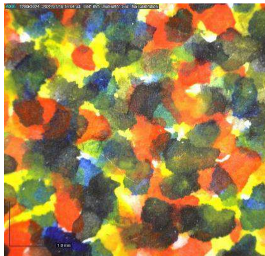
Figura 114. Detalle bajo microscopio con 55.0x aumentos de la probeta 3-A en la que se aprecian los espacios carentes de pintura.
