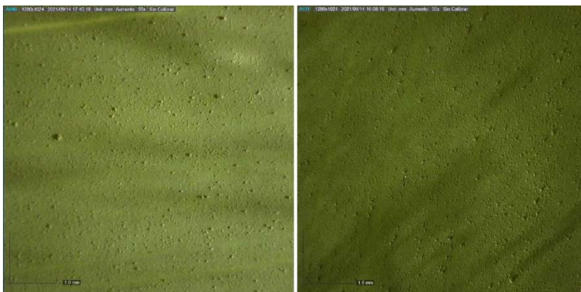
Figura 7. Detalle bajo microscopio con 55.0x aumentos de las piezas de ensayo de barniz de almáciga más pigmento verde óxido de cromo. A la izquierda, la probeta sin envejecimiento; a la derecha, la probeta tras su exposición a envejecimiento acelerado.
