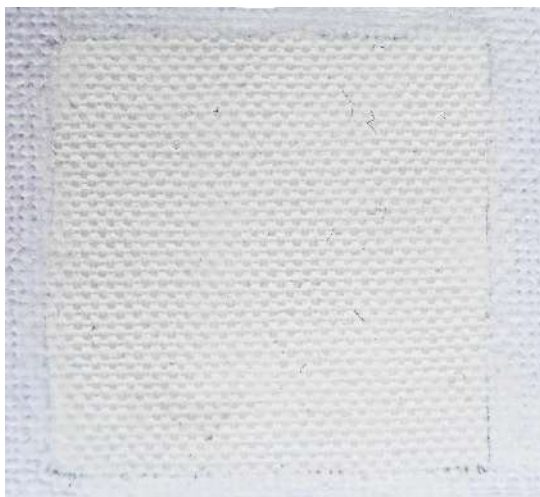
Figura 107. Ensayo de estuco comercial texturizado mediante la reproducción de la trama de una tela.
