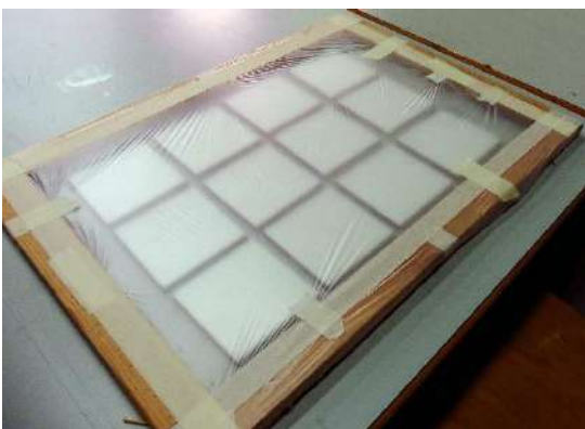
Figura 179. Detalle del proceso de secado de las probetas bajo un aislamiento a modo de campana de plástico.
