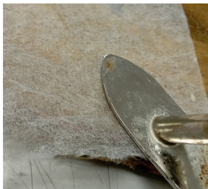
Fig.64.- Prueba de sensibilidad al calor
