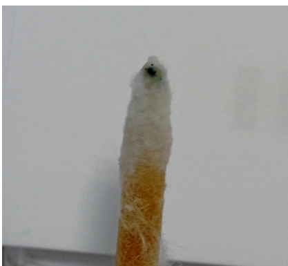
Fig.75.- Color del hisopo tras realizar una cata con LE8 sobre un repinte verde
